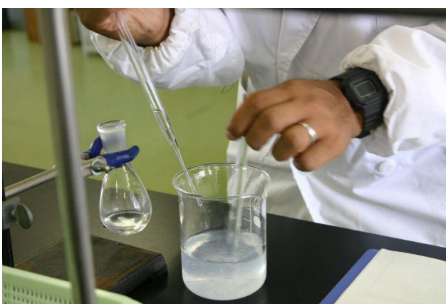
ポリマーの沈殿精製を行っています。重合溶液の 15 倍量のメタノールに滴下中。
