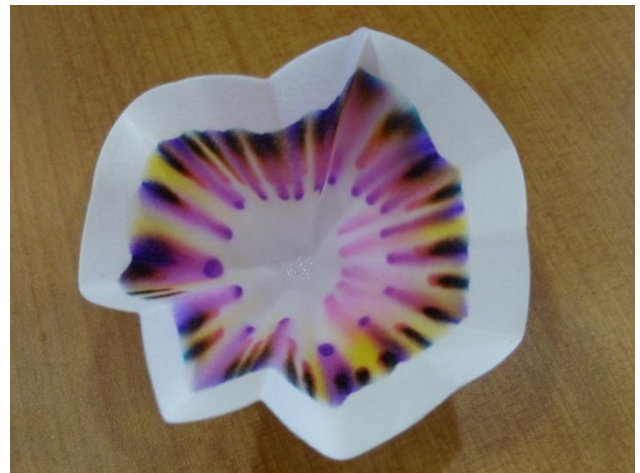
ろ紙の中心を水に浸すと、水が上に向かって移動し、インクも一緒に移動します。
