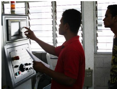
CNC 旋盤の NC プログラム編集。この後, 工具位置設定, 工具データ入力等を行い, 加工へと進む。
