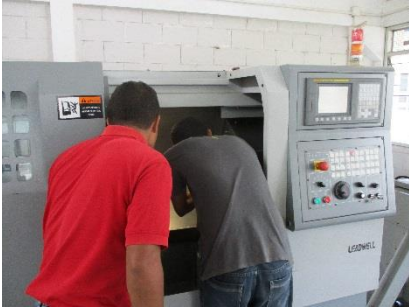
倣い加工に使用する工具を CNC 旋盤の刃物台にセッティングしている様子。
