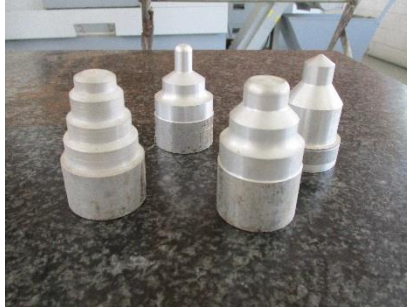
8 月の指導後, CNC 旋盤の工作実習を担当し実施している。写真は, CNC 旋盤工作実習での製作品。
