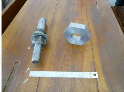
右が工作実習製作品。左は取付治具。彼ら自らが構築し，工作実習を実施している。
