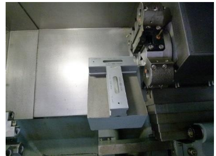
CNC 旋盤の刃物台に特殊な治具を取付けレベル調整を行う。調整ボルトが奥にあるため，時間を要した。
