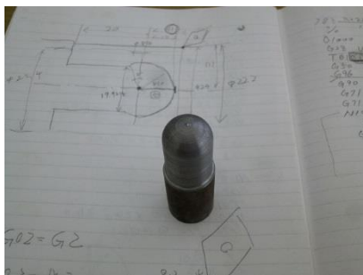
NC 旋盤による球体加工の製作品。リクエストによる例題。研究にも使用したいと考えている。
