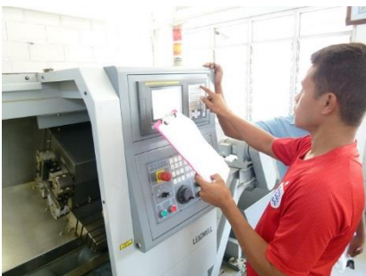
NC 旋盤の NC プログラム編集。この後，工具位置設定，工具データ入力等を行い，加工へと進む。
