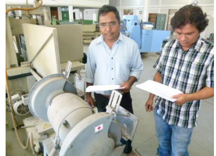
グラインダを例題に始業前点検を実施。
