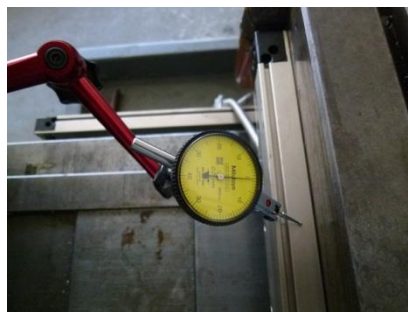
取り付け時、テストインジケータ にて平行を確認。
