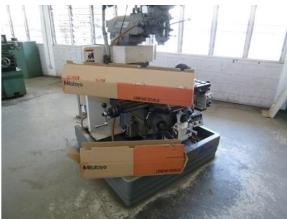
携行機材でのリニアスケール。 上が X 軸用、下が Y 軸用。 縦フライス盤のメンテナンス開始。
