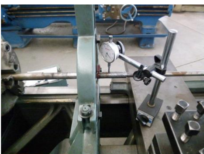
旋盤での固定振れ止めの使用。 軸の振れがないように調整する。
