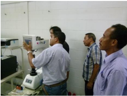
ロックウエル硬度計の測定子シリンドラを確認中
