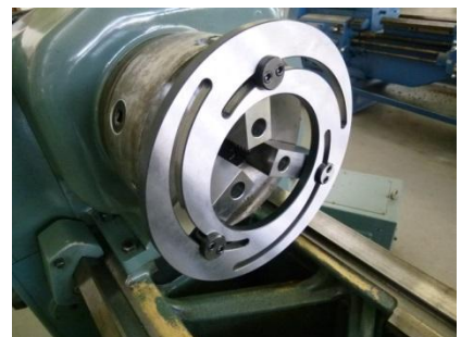
旋盤生爪成形用治具を取り付け、成形を行った
