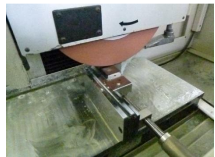
精密ブロックを平面研削盤にて仕上げ加工中
