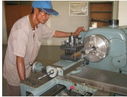
ピッチギアの合わせ方、スターの使い方等の指導を行った後、旋盤でのねじ切り作業の実習を行った
