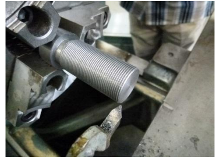
雄ねじ切り加工、できましたこれに合う、雌ねじ（ナット）も製作した
