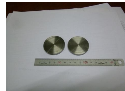
生爪を使用して、厚さ 5mm の円盤を製作
