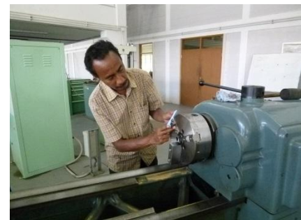
旋盤チャックの硬爪を生爪に取り替える
