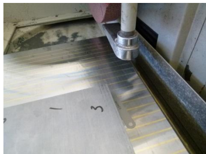
鋼板のそりに合わせ、すきまテープを入れる
