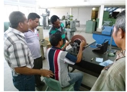
平面研削盤砥石のバランス調整中
