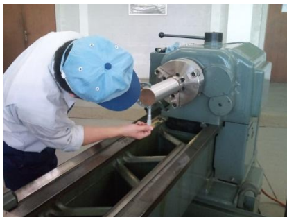
スクロールチャックを新品に交換し、主軸の振れを測定している
