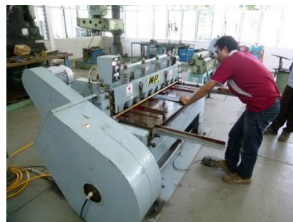
メンテナンスを終えたプレス切断機の試運転
