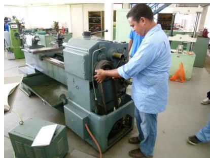
主軸の振れをダイヤルゲージで読み取るため、手で主軸を回す
