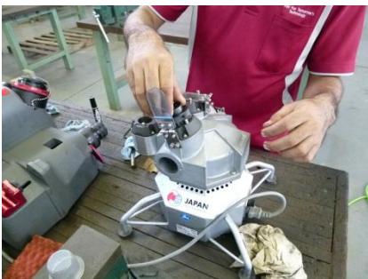
エンドミル研磨機、ドリル研磨機のメンテナンス
