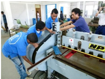
メンテナンス作業をひと通り終え、カバーを取り付ける
