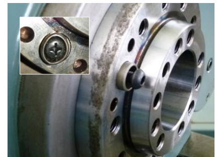
故障していたスクロールチャック取付け用の位置決め部品（白枠内）を交換
