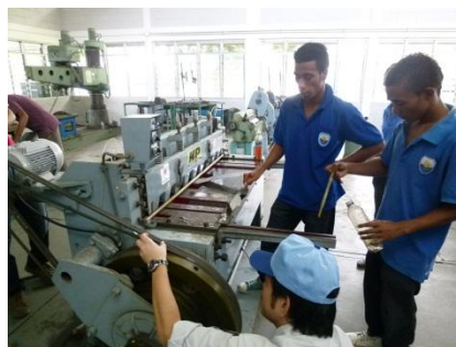
V ベルトの張り具合や、V 溝の汚れ等を入念にチェック
