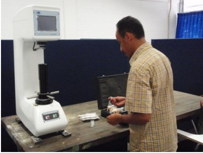
ロックウェル硬度計設置時の様子 測定子やステージの取り付け方の 説明を行った
