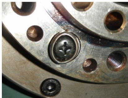
故障している旋盤の主軸部分 衝突による衝撃で、主軸の部品や チャック自身が壊れているため、 帰国後に対応
