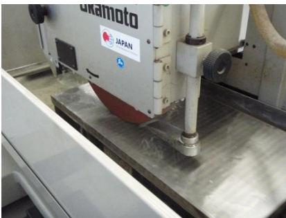
故障している平面研削盤 自動 でテーブルを左右に振る際に左 側に戻らない
