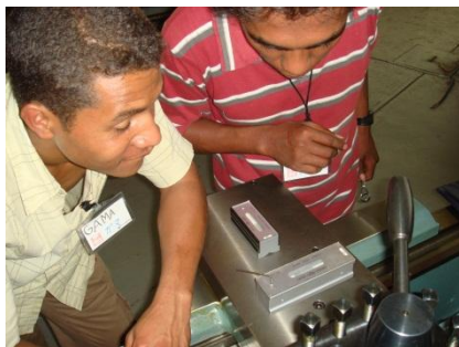
旋盤の水平出しおよび精度検査を行う
