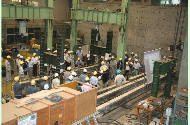
劣化した実橋の載荷実験の様子 (公開実験)
