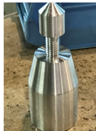
写真-1 ミニジャッキ
