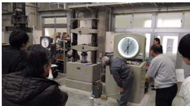
写真-3 コンクリート圧縮試験
