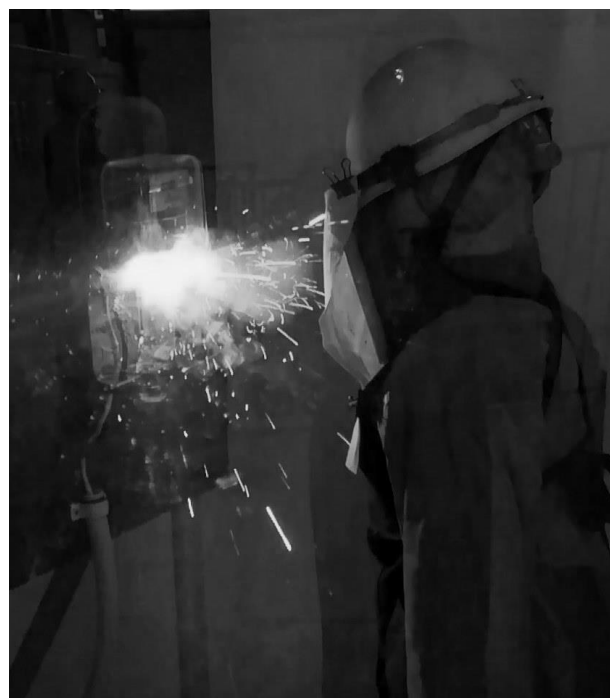
図 1. 低圧計器短絡再現(左：短絡させた 100V 電力計，右：ダミー人形，手前側にいる体験者の間には透明な保護板があります)
