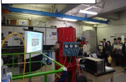
2. 遠心力で土砂崩壊実験
