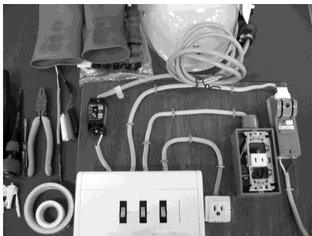
図1 低圧活線作業用ボードと使用工具
