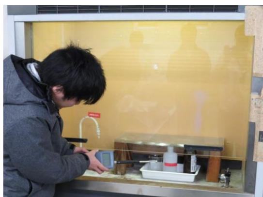
図3 ドラフト風速測定
